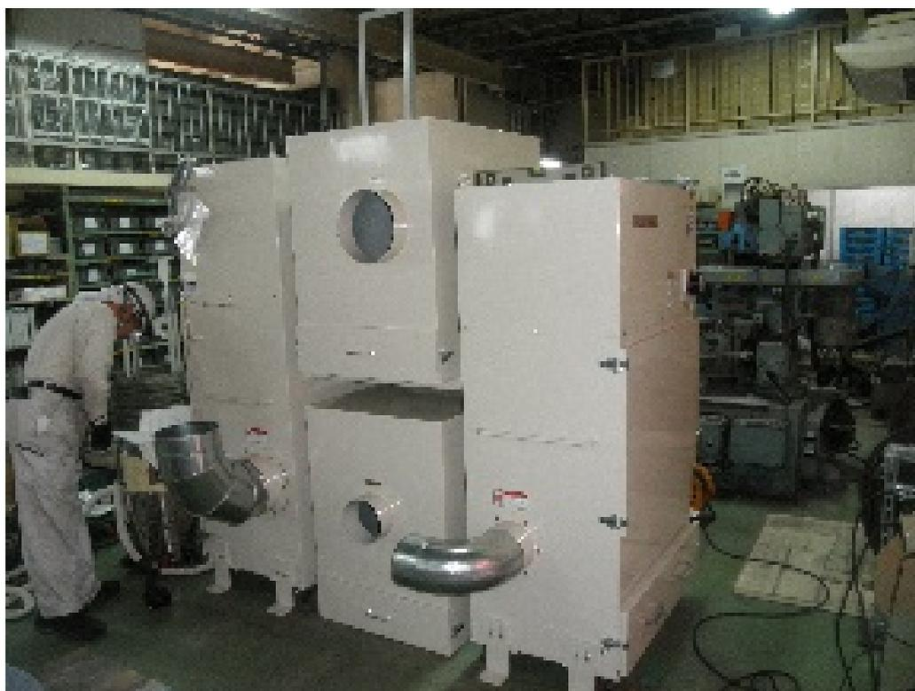
集塵機2台とスパッターボックス2台は立体的に組み合わせ設置スペースを最小とする
